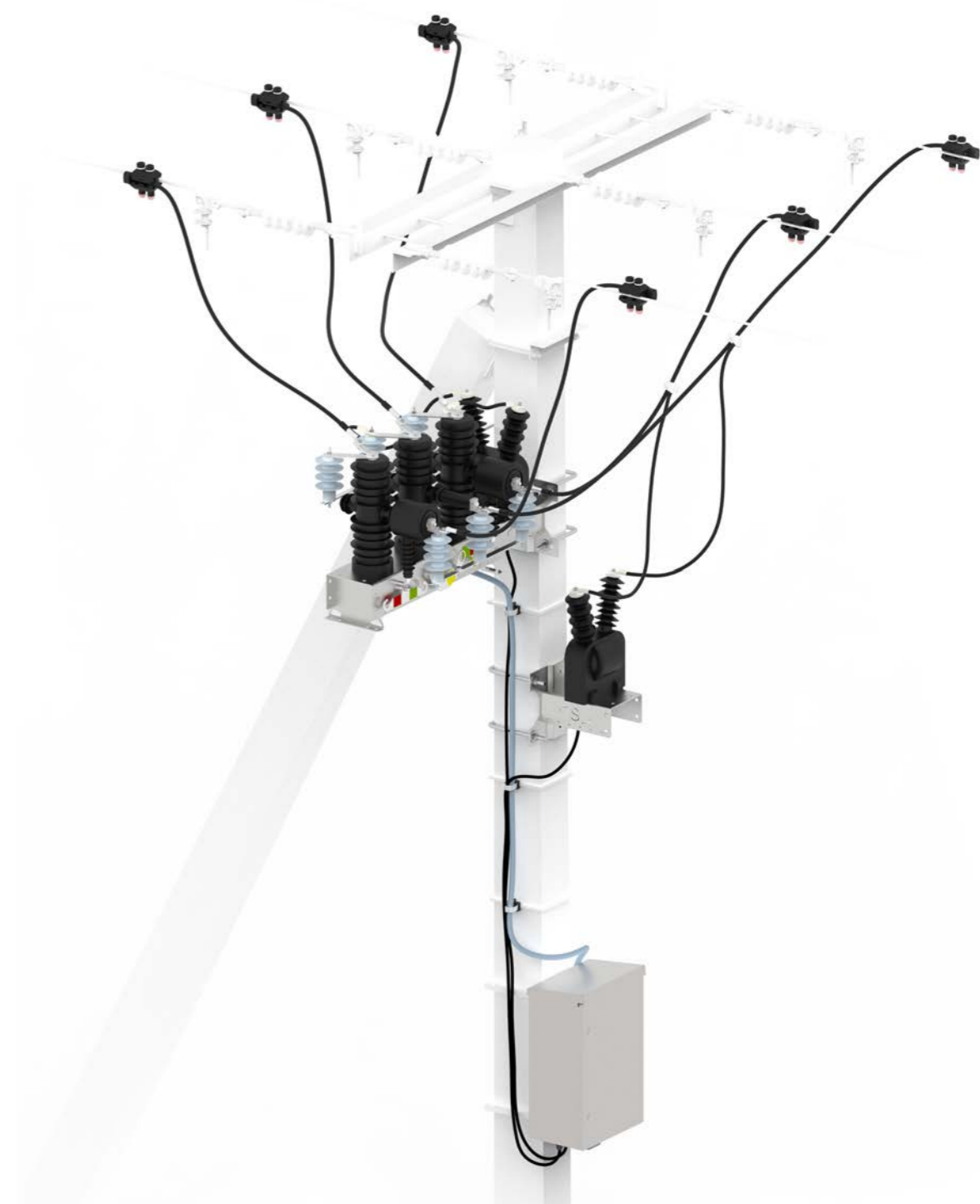
Рис. 2.2 - Розміщення комплекту встановлення SiAR12/2 на опорі
